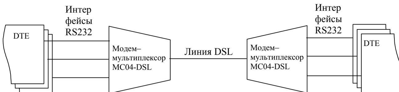
Рис. 4. Схема организации передачи данных по интерфейсам RS232.
